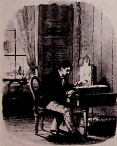
Wijzertelegraaf in gebruik bij de H.Y.S.M. De telegrafist draait aan het krukje tot de gewenste letter is bereikt.
